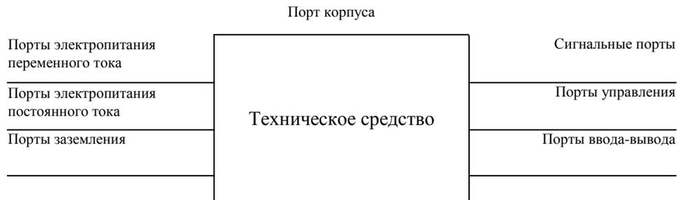
Рисунок 1 — Примеры портов технических средств и систем ОИАЭ
