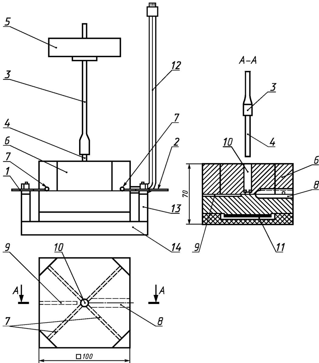
1, 2 — образцы провода; 3 — поршень; 4 — керамическая насадка поршня; 5 — груз; 6 — металлический блок; 7 — прорези для размещения образцов; 8 — отверстие для ввода устройства контроля температуры; 9 — отверстие для ввода термопары; 10 — отверстие для ввода поршня с грузом; 11 — электрический нагревательный элемент; 12 — устройство контроля температуры; 13 — изолированные выводы для присоединения образцов провода; 14 — изолирующее основание
