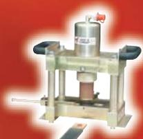
Для пробивки М6 – М14 (без изоляции) и резки гибких пластинчатых шин
