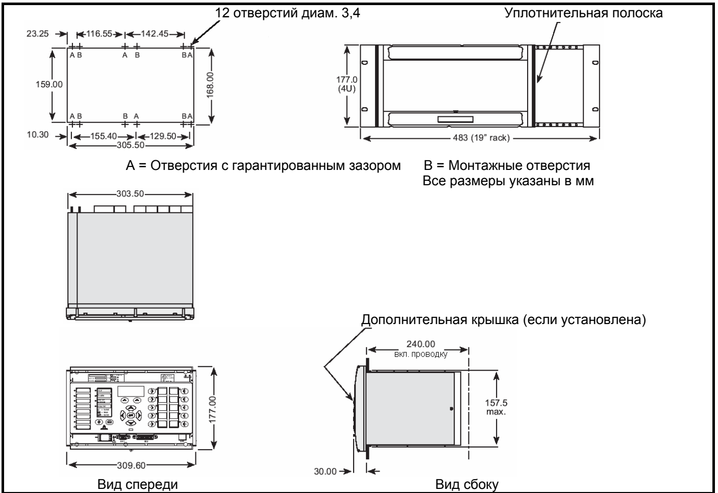
Размеры корпуса P342/3 (корпус 60TE)
