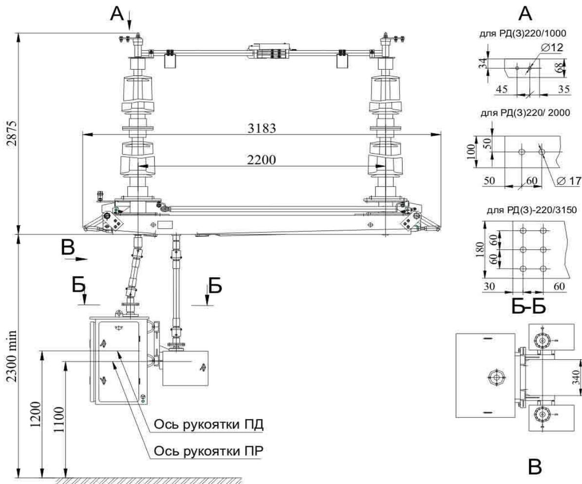
Установочные размеры полюса разъединителя
