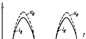
Рис. 16-2. Зависимость тока и напряжения от времени в схеме рис. 16-1.
