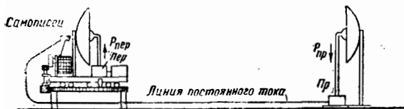
Рис. 25-123. Измерение диаграммы излучения.
