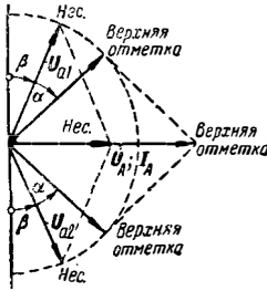
Рис. 21-38. Векторная диаграмма модуляции дефазированием (по Ширексу).
