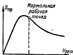
Рис. 17-8. Крутизна преобразования в зависимости от напряжения гетеродина при односеточном преобразовании.
