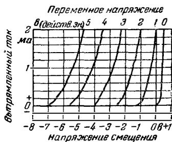
Рис. 11-21. Характеристики выпрямления (рабочие характеристики) диода.
