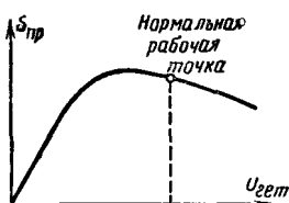
Рис. 17-9. Крутизна преобразования в зависимости от напряжения гетеродина при двухсеточном преобразовании частоты.
