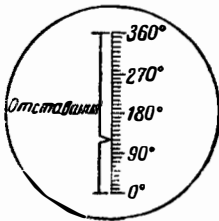
Рис. 25-34. Линейная шкала прибора для определения сдвига фаз импульсным методом.
