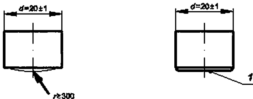
Сферическая поверхность бойка (А) Плоская поверхность бойка (В) d — диаметр бойка, r — радиус скругления ударной поверхности бойка. 1 — плоская поверхность бойка со скругленными кромками
