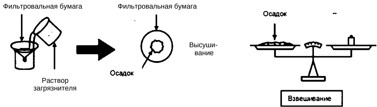
Рисунок С.5 — Методика измерения ПНО
