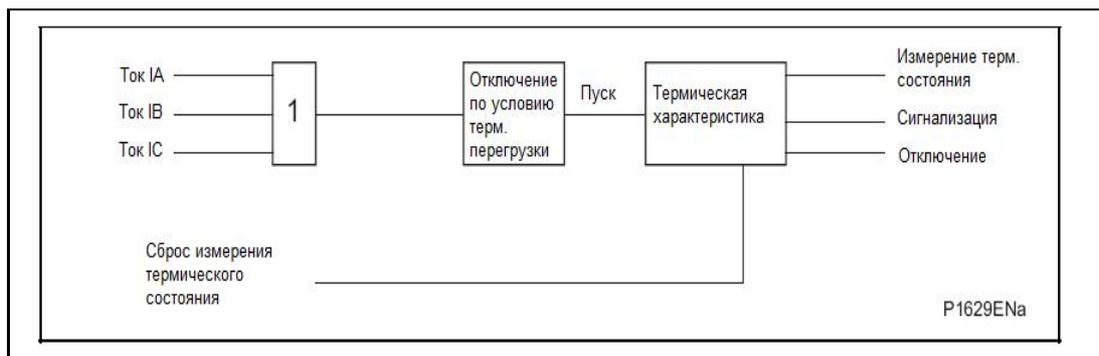
**Рис. 5: Логическая схема работы функции защиты от термической перегрузки**
