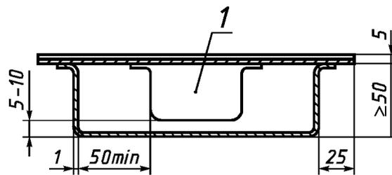
Рисунок 7 — Испытательный кожух для тепловых испытаний ПРА
