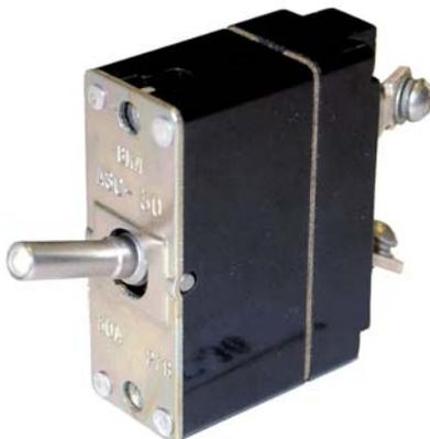
Автоматы предназначены для работы в стационарных и передвижных установках и служат для автоматического отключения потребителей электроэнергии при перегрузках и коротких замыканиях в цепях постоянного тока при напряжении до 30В. Выпускаются на номинальные токи 2, 5, 10, 15, 20, 25, 30 и 40А. Могут использоваться в качестве выключателей и элементов защиты электрооборудования различных видах техники, в том числе в автомобилях, тракторах, железнодорожном и речном транспорте.
