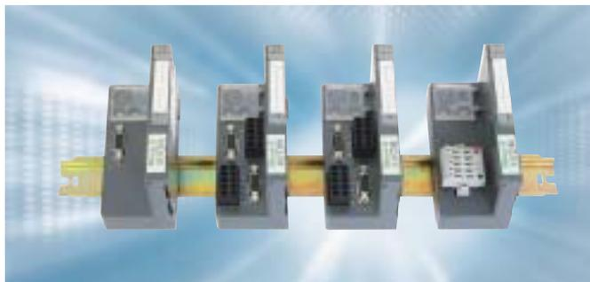
Сетевые модули (шлюзы) позволяют использовать модули ввода-вывода независимо от полевой шины. Каждый шлюз функционирует в качестве подчиненного модуля в определенной сети передачи данных. Адрес абонента сети устанавливается с помощью вращающихся кодирующих переключателей или DIP-переключателей на передней панели.
