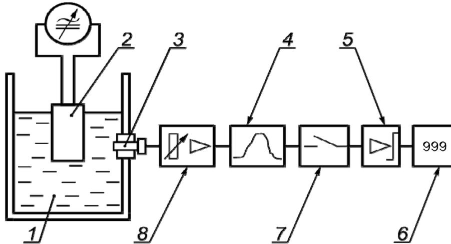
1 — ванна с водой; 2 — испытуемый образец; 3 — высокочастотный микрофон чувствительностью 80 рс/бар, номинальной частотой 65 кГц; 4 — ряд выходных фильтров от 40 до 80 кГц (минус 3 дБ); 5 — усилитель и формователь импульса; 6 — электронный счетчик; 7 — регулируемый прерыватель с временем отключения от 5 до 50 мс; 8 — делитель и предусилитель с максимальной входной чувствительностью  $\geq 1 \text{ мВ}_{\text{эфф}}$  и входным сопротивлением 60 кОм
