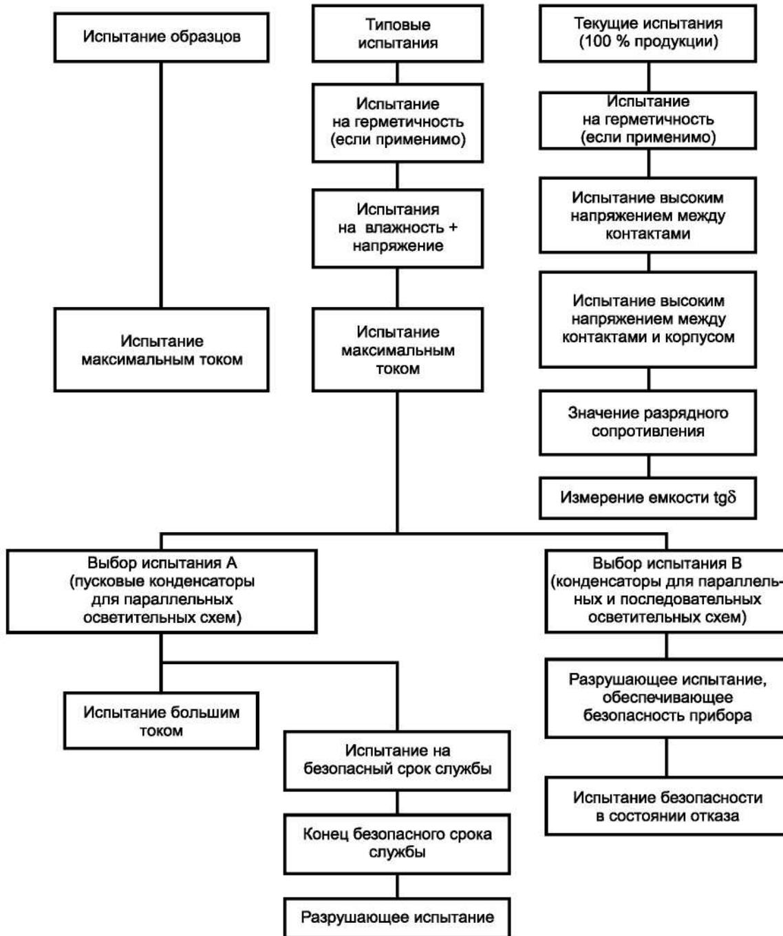
Рисунок 4 — Схема процедуры испытаний
