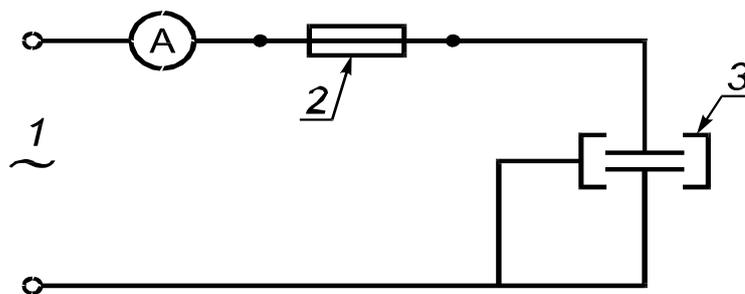
1 — источник переменного напряжения; 2 — плавкий предохранитель;
