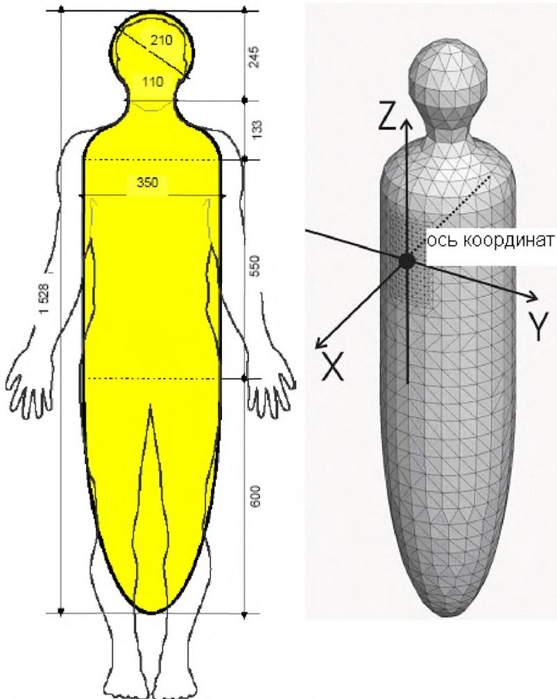
Рисунок D.3 – Цифровая однородная модель тела человека (размеры указаны в мм)
