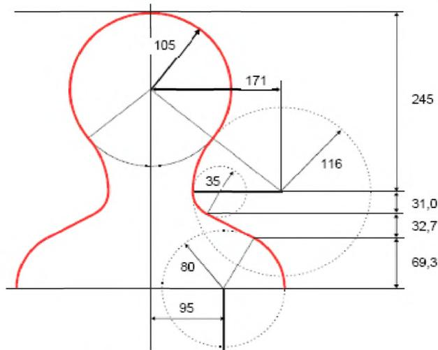
Рисунок D.4 – Деталировочный чертеж модели головы и плеч
