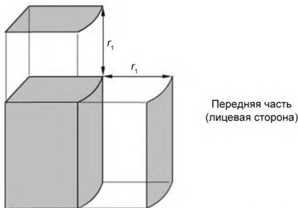
Рисунок А.1 – Измерительное положение верх/передняя часть (см. 3.2.7)
