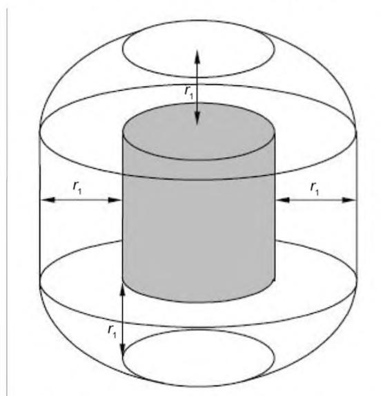
Рисунок А.2 – Измерительное положение вокруг (см. 3.2.7)
