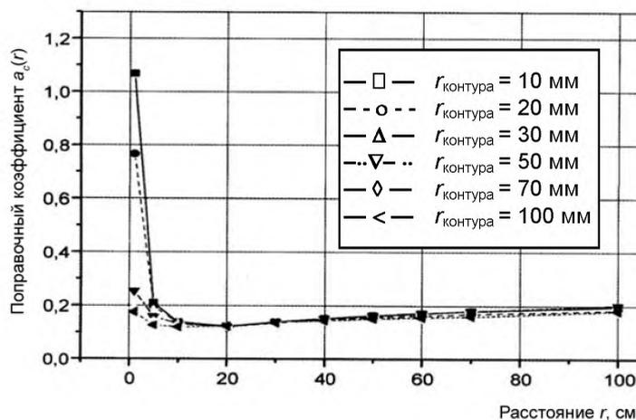
Рисунок С.5 – Поправочный коэффициент  $a_c(r_1)$  для полей с удельной электропроводностью 0,1 См/м и датчиком площадью  $A_{\text{датчика}} = 100 \text{ см}^2$  для модели тела человека (применяются шкалы значений пределов согласно ICNIRP [11])
