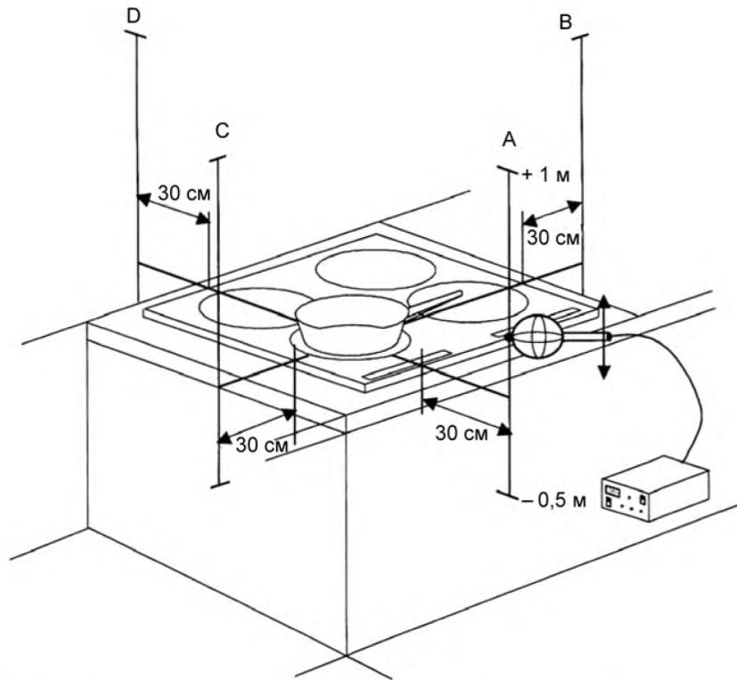
Линиями А, В, С и D обозначены позиции датчика при проведении измерений.
