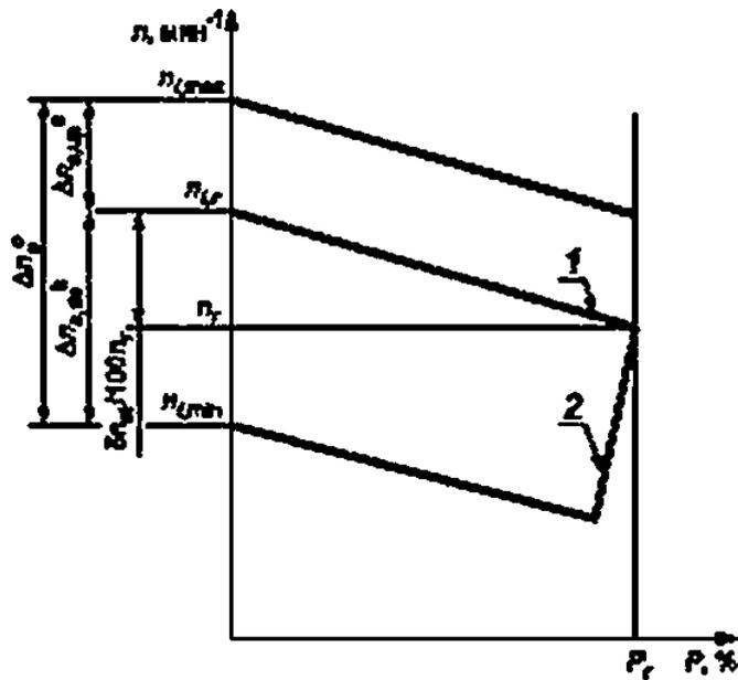
— мощность двигателя;  $n$  — частота вращения двигателя; в — верхний диапазон уставки частоты вращения; б — нижний диапазон уставки частоты вращения; с — диапазон уставки частоты вращения; 1 — характеристика частота вращения/мощность; 2 — предельное значение мощности
