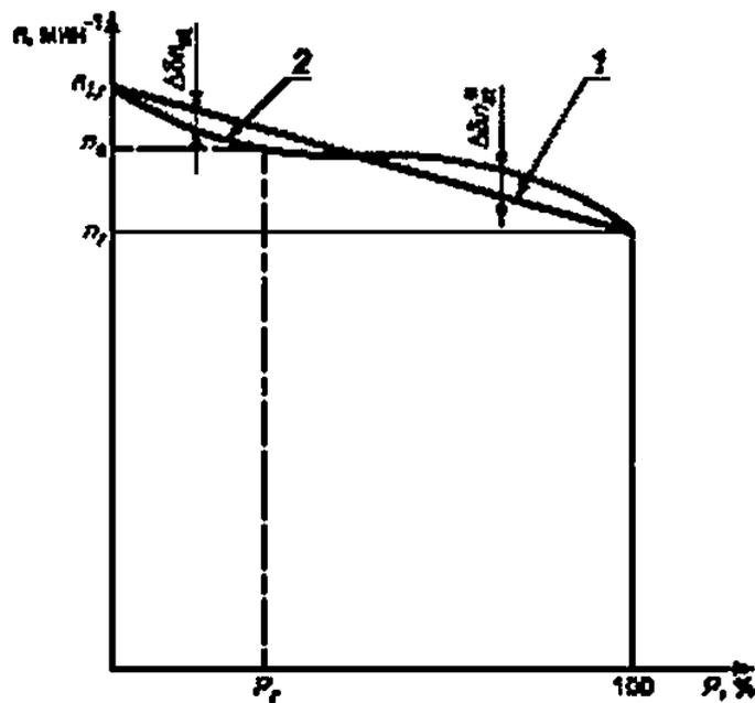
— мощность двигателя;  $n$  — частота вращения двигателя; а — отклонение характеристики частота вращения/мощность,  $>$  ~ линейная характеристика частота вращения/мощность; 2 — характеристика частота вращения/мощность
