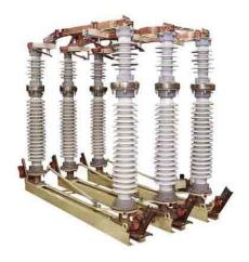
Двухколонковый, горизонтально – поворотного типа, наружной установки предназначен для включения и отключения обесточенных участков электрической цепи высокого напряжения, а также заземление отключенных участков с помощью заземлителей. Изготавливается для поставок внутри страны и на экспорт
