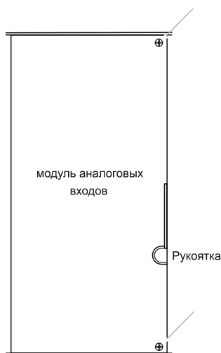
Рис. 13: Расположения винтов крепления модуля аналоговых входов
