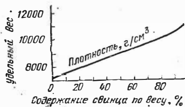
Рис. 14.1. Плотность оловянисто-свинцовистых сплавов.
