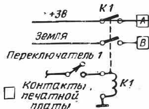
Рис. 16.9. Один переключатель на две независимые схемы.
