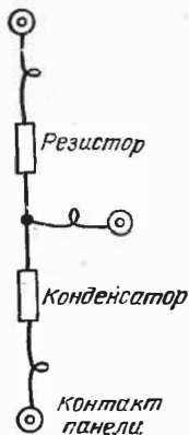
Рис. 16.12. Коммутационная панель со схемными компонентами.
