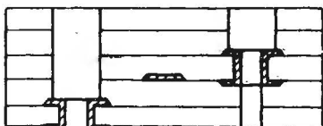
Рис. 5.17. Многослойная печатная плата с открытыми контактными площадками, при изготовлении которой использованы двухсторонние платы с металлизированными отверстиями.
