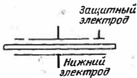
Рис. 2.10. Введение защитного электрода при измерении объемного сопротивления.
