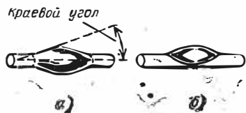
Рис. 14.5. Внешний вид капель припоя в соответствии с техническими условиями:
