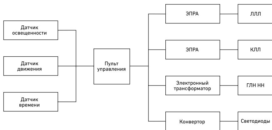
Рис. 58. Структурная схема СУО. Очевидно, что «сердцем» СУО являются электронные аппараты включения источников света, позволяющие регулировать световой поток ламп. При этом регулирование должно быть как автоматическим – от датчиков (освещенности, присутствия, времени), так и ручным (непосредственно самими работающими). Управление может быть аналоговым, цифровым или потенциометрическим.
