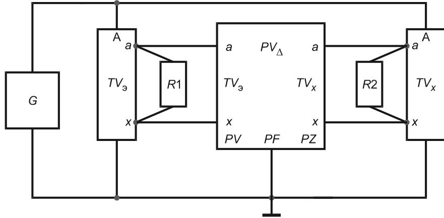
$G$  — источник высокого напряжения;  $TV_3$  — эталонный трансформатор;  $R1$  — нагрузочное устройство эталонного трансформатора;  $TV_x$  — поверяемый трансформатор;  $R2$  — нагрузочное устройство поверяемого трансформатора;  $PV_{\Delta}$  — прибор сравнения;  $PV$  — функция измерения входного напряжения;  $PF$  — функция измерения частоты входного напряжения;  $PZ$  — функция измерения нелинейных искажений
