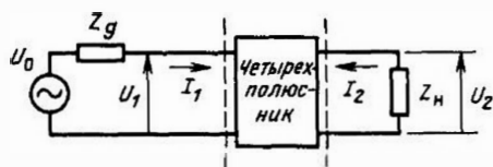
Рис. 6.1. Общая схема четырехполюсника
