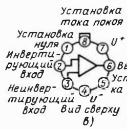
Рис. 12.2. Схема ОУ (а), различные способы включения ИС LM4250 (б), выполненные в металлическом (в), двухрядном (г) и плоском (д) корпусах
