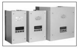
Устройство плавного пуска и торможения представляет собой тиристорное переключающее устройство (регулятор напряжения по трем фазам), обеспечивающее плавный пуск с включением внешнего шунтирующего контактора и остановку трехфазных асинхронных двигателей с короткозамкнутым ротором. Оно объединяет функции плавного пуска и торможения, защиты механизмов и двигателей, а также связи с системами автоматизации.
