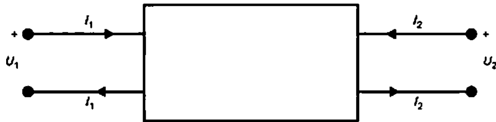
Рисунок 1 — Условные обозначения, используемые в электрических цепях
