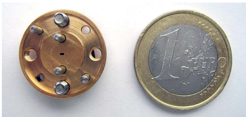
Рис. 8.5.4 MIL-F-3922/67B-M03 волноводный фланец с монетой для сравнения размеров.
