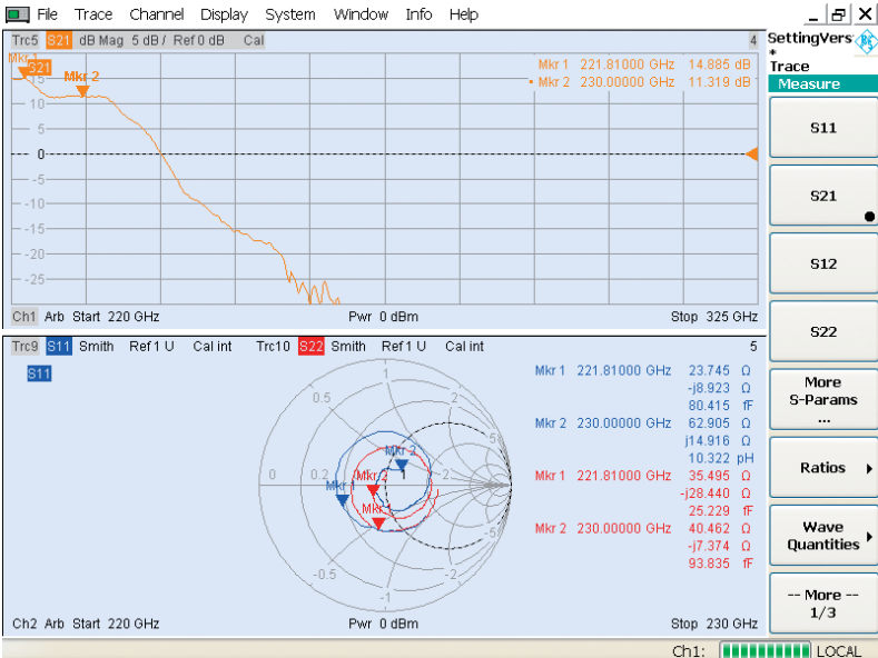
Рис. 8.5.6 Исследование усилителя миллиметрового диапазона.
