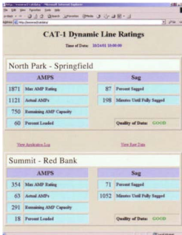
Рисунок 3. Отображение показаний САТ-1 на экране оператора линии в реальном времени
