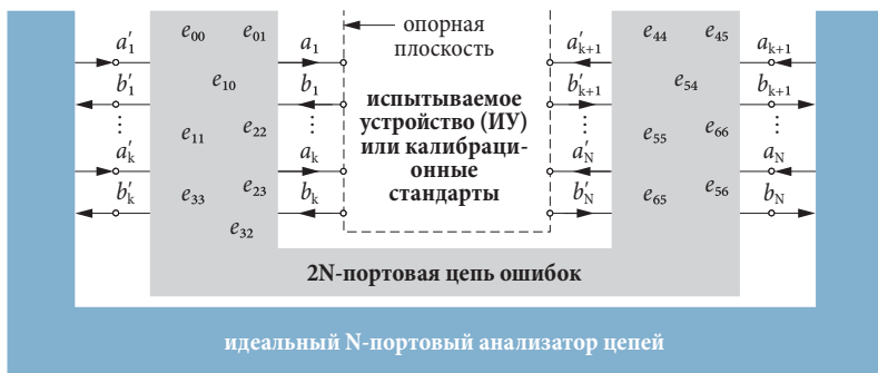
Рис. 3.2.2 Виртуальное разделение реального N-портового анализатора цепей на выделенную 2N-портовую цепь ошибок и идеальный N-портовый анализатор цепей.
