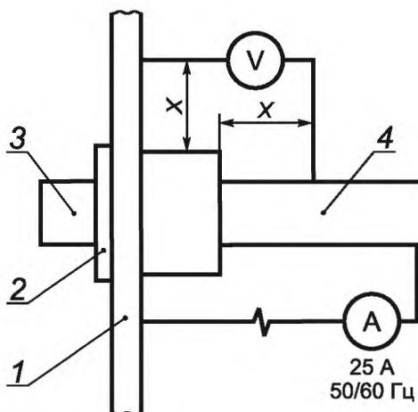
$X = (12 \pm 2)$  мм; 1—3 — миллиметровая стальная пластина; 2 — дополнительная натяжная гайка; 3 — концевая трубная арматура, прикрепленная к пластине сквозным болтом или на резьбе самой арматуры; 4 — труба
