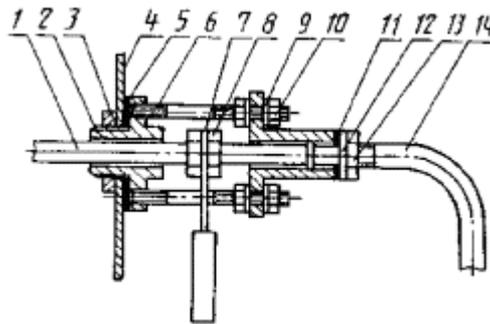
1 - воздухозаборная трубка; 2 - втулка; 3 - гайка; 4 - стенка камеры; 5 - прокладка; 6 - шпилька; 7 - рукоятка; 8 - гайка; 9 - шайба; 10 - гайка; 11 - прокладка; 12 - шайба; 13 - гайка; 14 - соединительная труба
