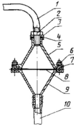
1 - трубка соединительная; 2 - гайка; 3 - шайба; 4 - прокладка; 5 - крышка; 6 - гайка; 7 - винт; 8 - фильтр; 9 - крышка; 10 - трубка резиновая
