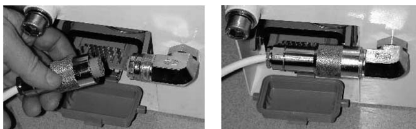
Рис. 4.19. Подключение внешнего оперативного питания
