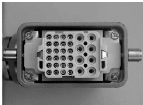
Рис. П4. Разъемы соединительного кабеля СС/TEL со стороны OSM/TEL (слева) и RC/TEL (справа)
