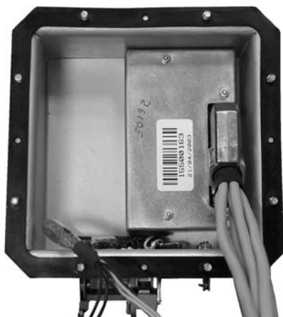
Рис. 3.10. Защитная крышка разъема вторичных цепей и штепсельный разъем
