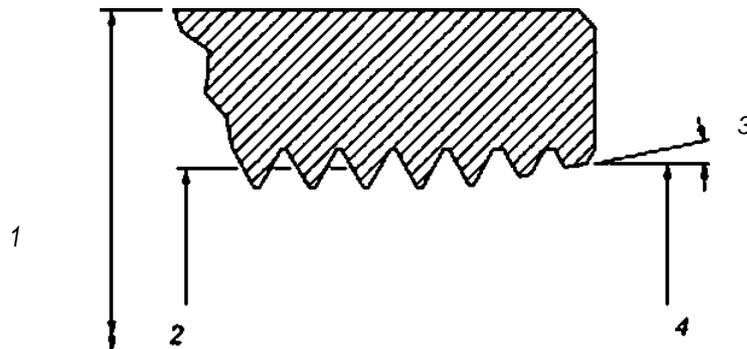
1 — внешний диаметр. 2 — средний диаметр. 3 — угол закругления кромок. 4 — диаметр закругления кромок
