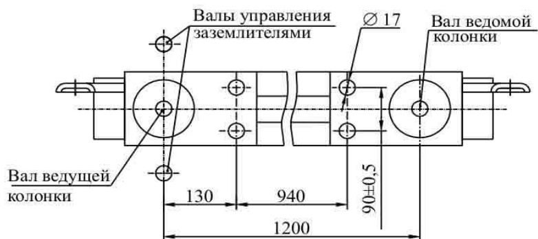
Установочные размеры полюса разъединителя
