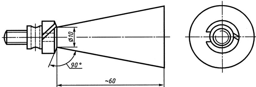
Рисунок 1 — Коническая оправка
