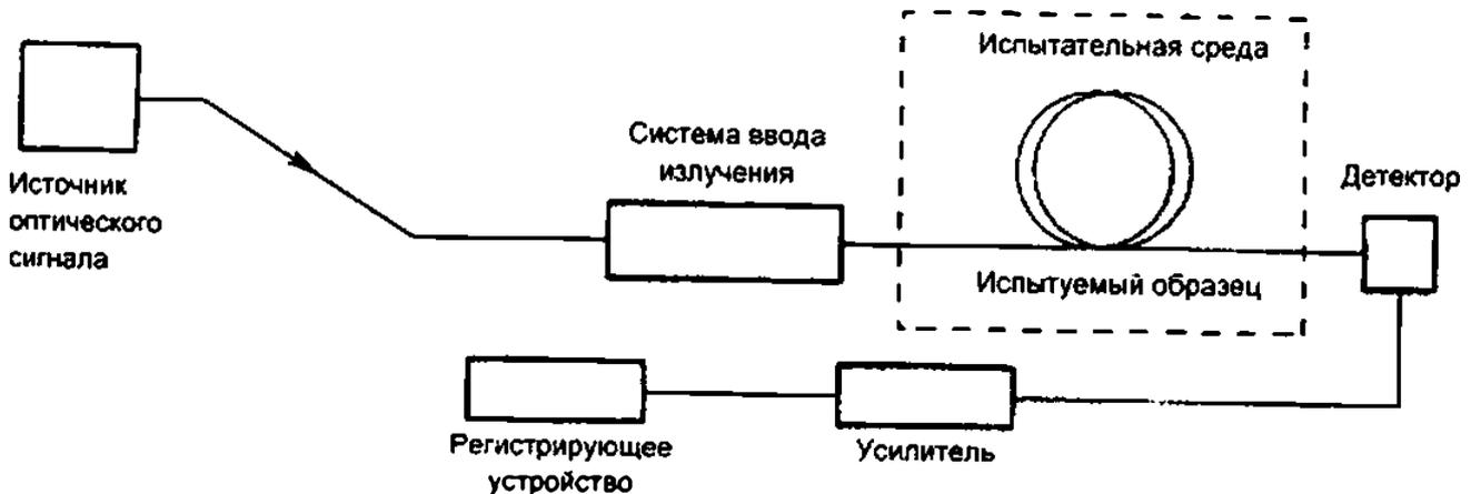
Рисунок А.2 – Измерение изменения коэффициента оптического пропускания с использованием стабилизированного источника
