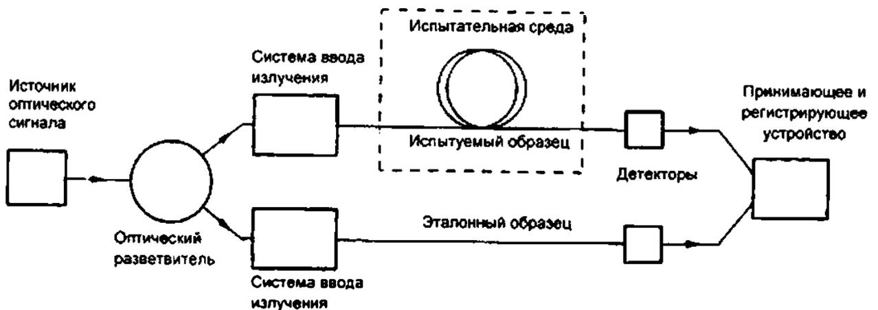
**Рисунок А.1 – Измерение изменения коэффициента оптического пропускания**
